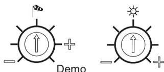
Die Wind-/Sonnenschwellwerte können anhand der Potentiometer **Wind**, **Sonne**, am Soliris Sensor RTS eingestellt werden. (Wind von ca. 10-50 km /h, Helligkeit ca. 0-50 kLux.)
