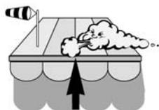
Wenn die Windgeschwindigkeit den am **Wind** eingestellten Wert übersteigt, wird ein Auf-Befehl gesendet. In diesem Zustand wird jeder manuell gegebene Fahrbefehl und jeder Sonnenautomatik-Fahrbefehl unterbunden.
