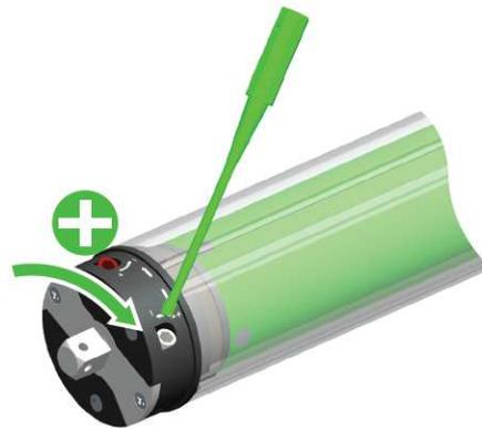
Drehen Sie den weißen Drehknopf mit dem Einstellungsstab in Richtung „+“, bis Sie die gewünschte Endlagen-Position erreichen.
