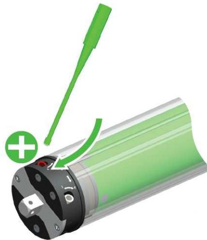
Drehen Sie den roten Drehknopf mit dem Einstellungsstab in Richtung „+“, bis Sie die gewünschte Endlagen-Position erreichen.
