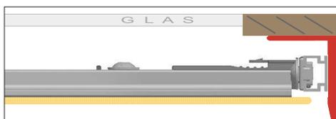
Sie können mittels **Montagewinkel** die Sunola Sonnenschutzsysteme auch außer- bzw. unterhalb einer Nische montieren. Bitte achten Sie auf die jeweilige Montagesituation.
