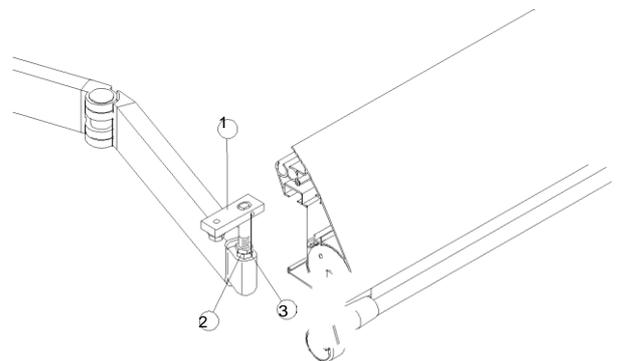
**Lösung:** Montieren Sie die Konsolen auf die vorgeschriebenen Punkte (Aufkleber an der Markise).
