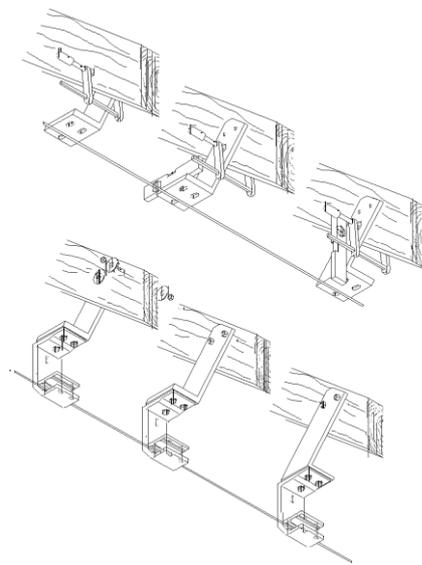
Schlagen Sie den Scheibendübel (4) mit einem Hammer über das Bohrloch in den Sparren (2).
