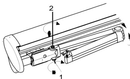
**Achten Sie darauf, dass sich die Kerbe (=X) der Armlagerschraube im hinteren Bereich der Armgabel (Richtung Tuchwelle) befindet.**
