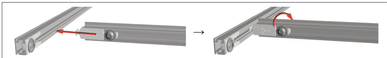
Stopper-Set mit Magnet - zum Arretieren bei Dachneigung
