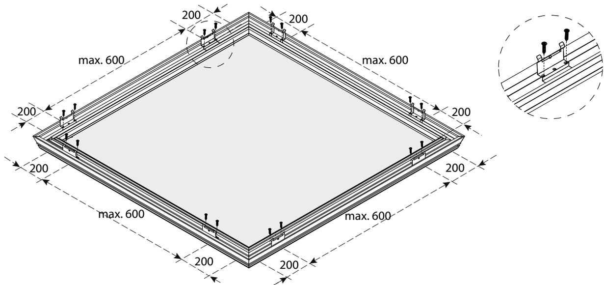
Drehen Sie das komplette System um und stellen Sie dieses über den Aufsatzkranz! Sorgen Sie dafür, dass die Klipsen, komplett mit Fenster und Glas, nicht direkt auf die Dachbedeckung oder auf den Untergrund gepostet werden (um möglicher Beschädigung an der Dachbedeckung oder an den Klipsen vorzubeugen).
