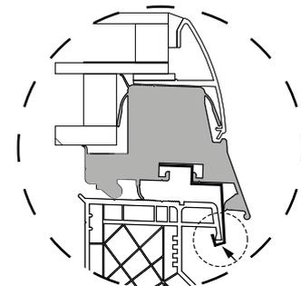
Für eine zusätzliche Verstärkung, bitte schrauben Sie die Klipsen quer durch den Aufsatzkranz mit mitgelieferten (Einweg)Schrauben.
