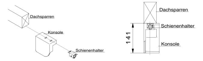
Mitte Bohrungen Konsole ist auch gleich Mitte Bohrungen der Schienenhalter. Dieses Maß ist gleichzeitig auch das Achs- und das Bestellmaß der Markise.
