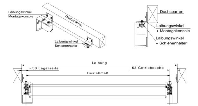
Mitte Langloch Laibungswinkel Konsole ist auch gleich Mitte Langloch Laibungswinkel der Schienenhalter. Dieses Maß ist gleichzeitig auch das Achs- und das Bestellmaß der Markise.
