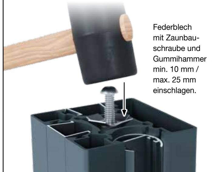
Federblech mit Zaunbauschraube und Gummihammer min. 10 mm / max. 25 mm einschlagen.
