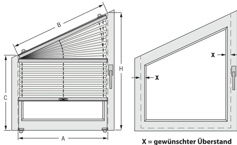
⚠ Prüfen Sie, ob der Klemmträger hinsichtlich Fenstermechanik und der Distanz zur Fensterbank eingesetzt werden kann (Stärke Fensterflügel max. 25 mm). Beim Aufmaß auf vorstehende Beschläge achten.
